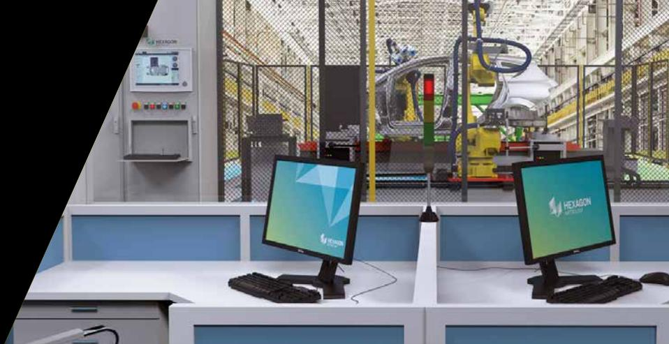
Фиксированные датчики также могут использоваться для проверки серийных номеров, что необходимо для концепции «интеллектуальный объект». Первый робот разбирает заготовки, помещая их либо на фиксирующую систему, либо направляя непосредственно в область контроля. Затем датчик белого света, смонтированный на втором роботе, выполняет необходимые измерения, в соответствии с программой, заданной ПЛК. По окончании проверки заготовки возвращаются на склад, или же сортируются по результатам контроля.
