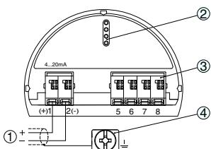
Отсек электроники и подключения в однокамерном корпусе
