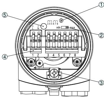
Отsek электроники и подключения - релейный выход
