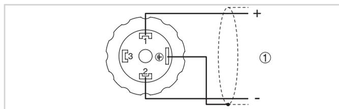
Схема подключения для углового штекерного разъема по ISO 4400, вид сверху на подключение со стороны устройства
