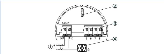
Отсек электроники и подключения в однокамерном корпусе
