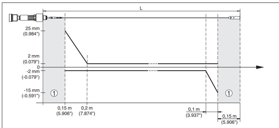
Рис. 54: Погрешность измерения VEGAFLEX 86 в тросовом исполнении  $\varnothing$  4 мм, продукт - масло
