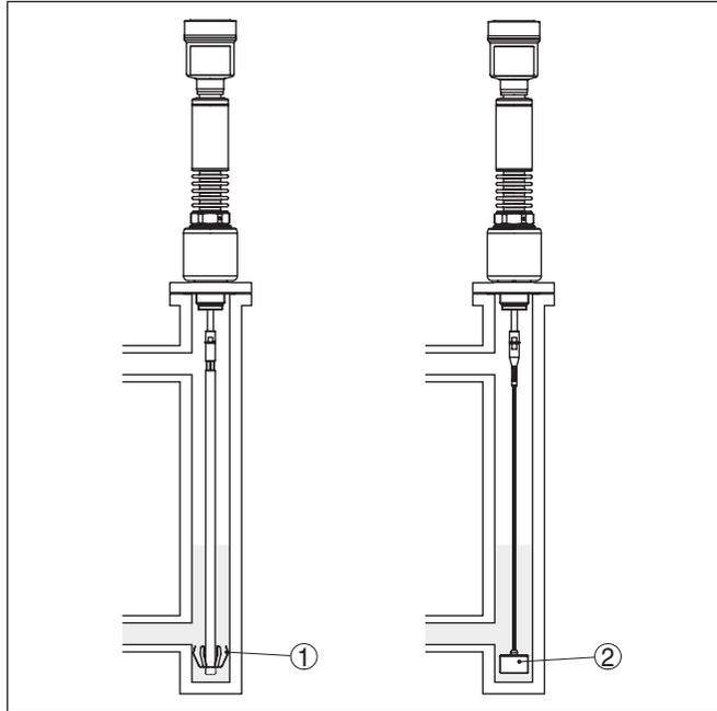
Рис. 12: Положение центрирующей звездочки или центрирующего груза
