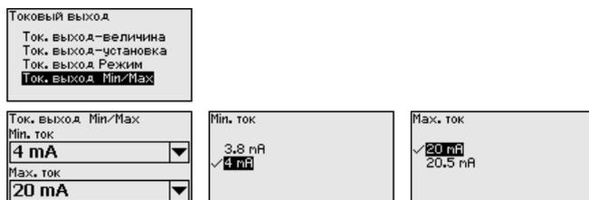
Заводская установка: Min.-ток 3,8 mA и Max.-ток 20,5 mA.
