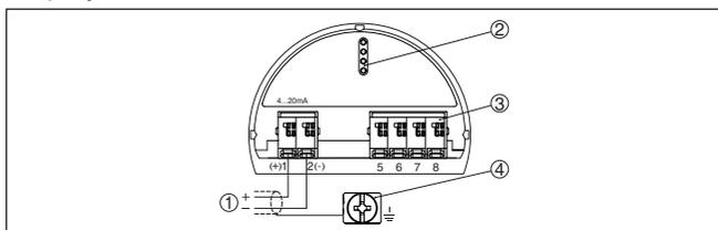
Рис. 2: Отсек электроники и подключения (однокамерный корпус)
