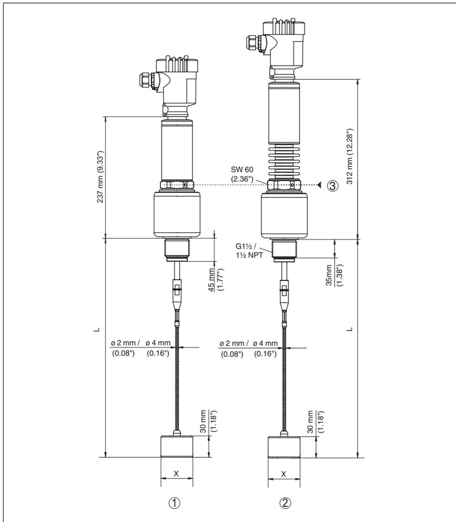
Рис. 64: VEGAFLEX 86, резьбовое исполнение с центрирующим грузом
