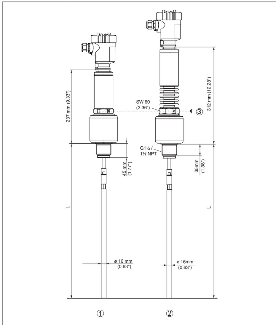
Рис. 65: VEGAFLEX 86, резьбовое исполнение
