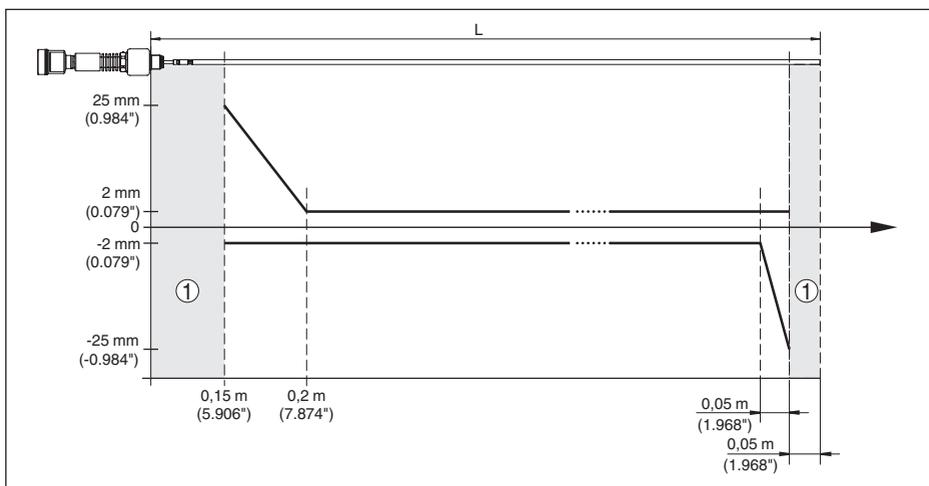
Рис. 51: Погрешность измерения VEGAFLEX 86 в стержневом исполнении (продукт - масло)
