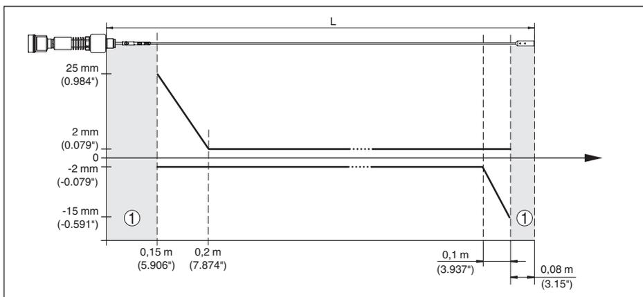
Рис. 53: Погрешность измерения VEGAFLEX 86 в тросовом исполнении  $\varnothing$  2 mm (0.079 in), продукт - масло
