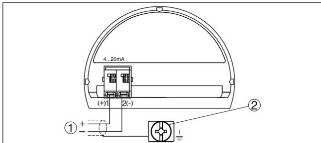
Рис. 23: Отсек подключения (двухкамерный корпус Ex d)
