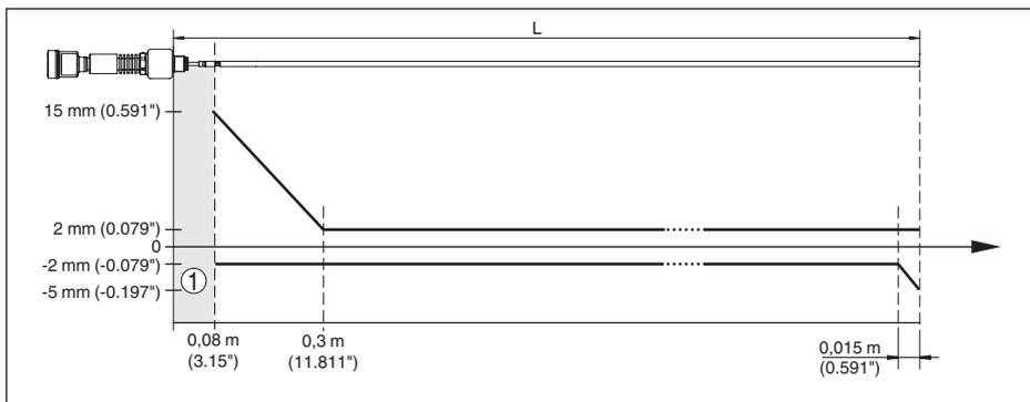
Рис. 50: Погрешность измерения VEGAFLEX 86 в стержневом исполнении (продукт - вода)
