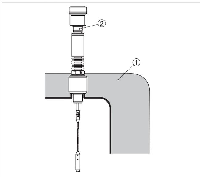
Рис. 13: Монтаж устройства на емкости с термоизоляцией
