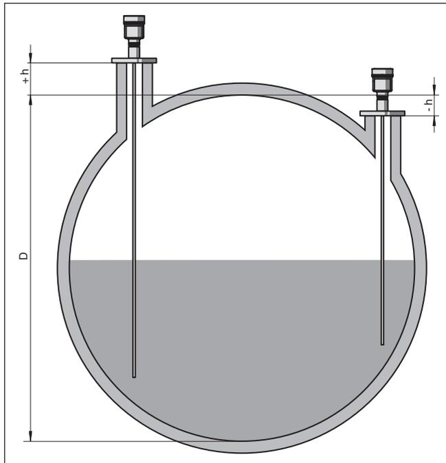
Рис. 32: Высота емкости и значение коррекции патрубка
