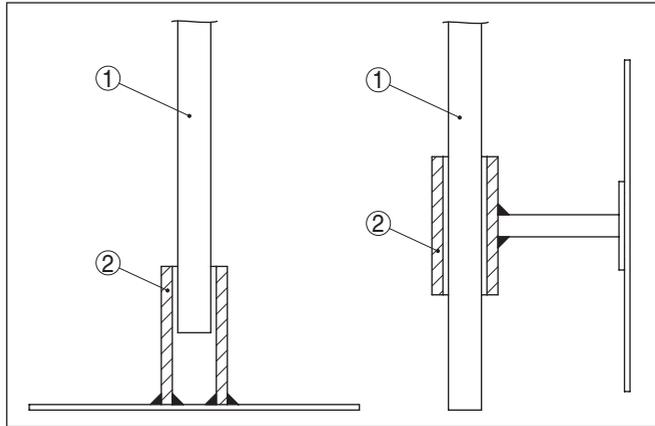
Рис. 14: Фиксация измерительного зонда
