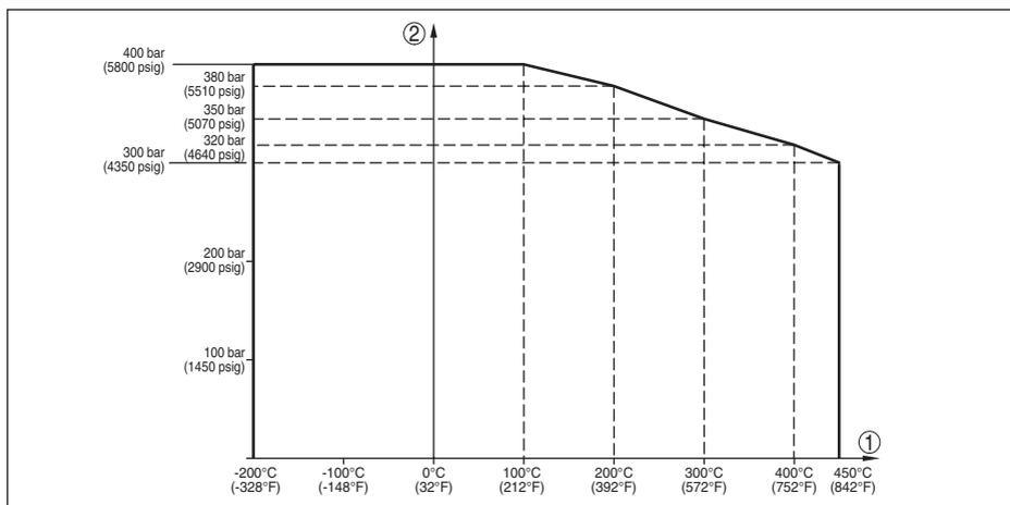
Рис. 57: Давление процесса - температура процесса (исполнение -196 ... +450 °C/-321 ... +842 °F)
