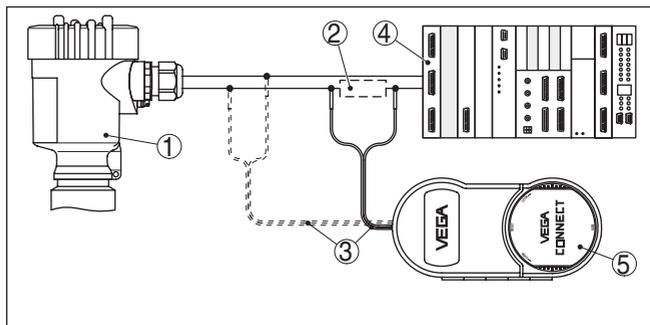
Рис. 34: Подключение ПК к сигнальному кабелю через HART
