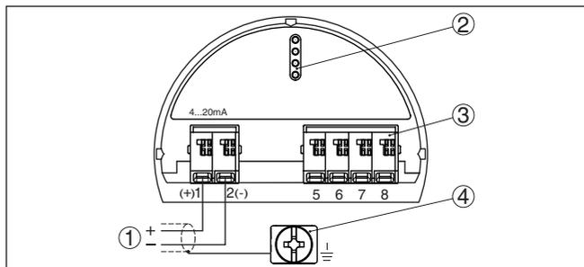
Рис. 18: Отсек электроники и подключения (однокамерный корпус)
