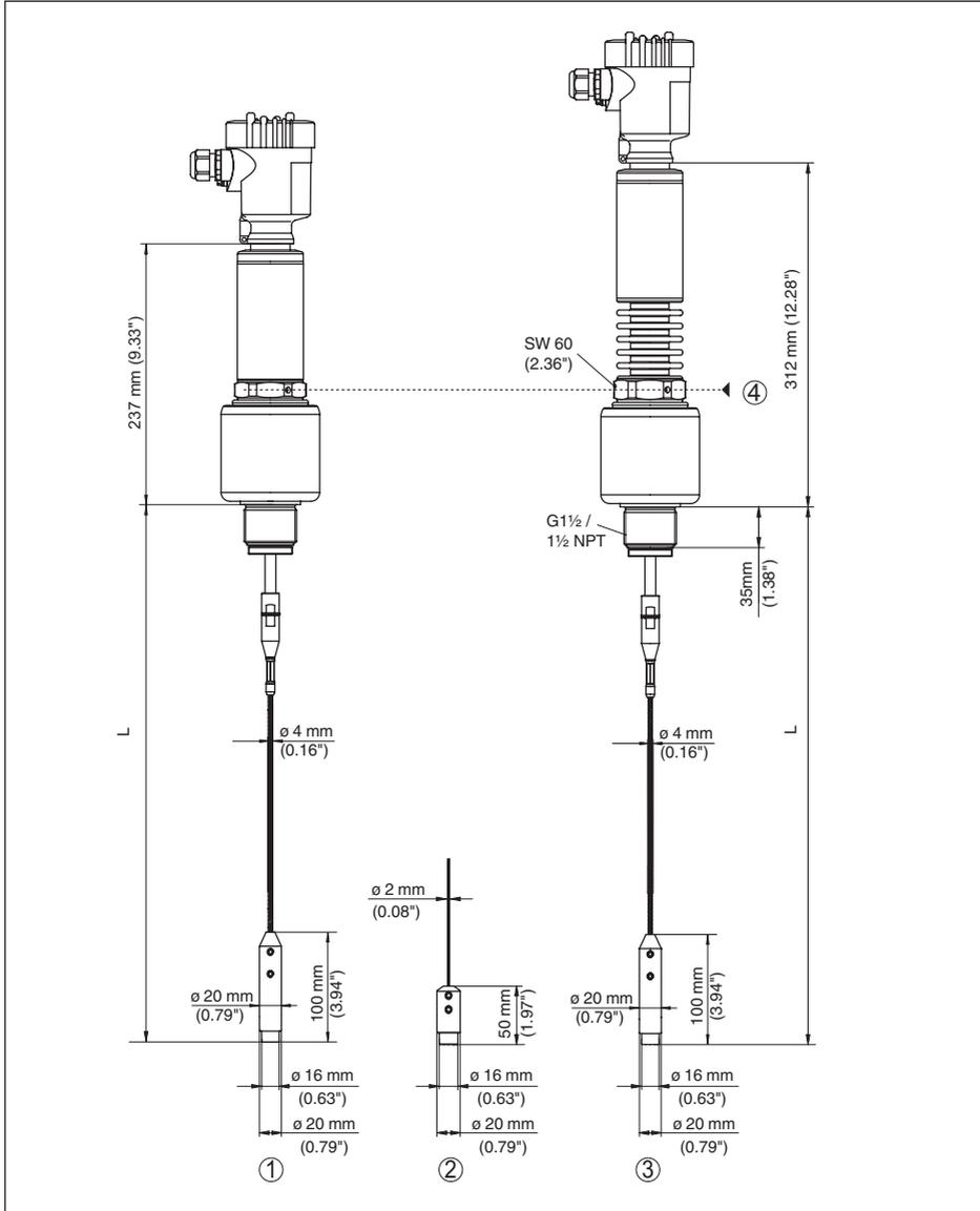
Рис. 63: VEGAFLEX 86, резьбовое исполнение с натяжным грузом (все натяжные грузы с резьбой M8 для рым-болта)
