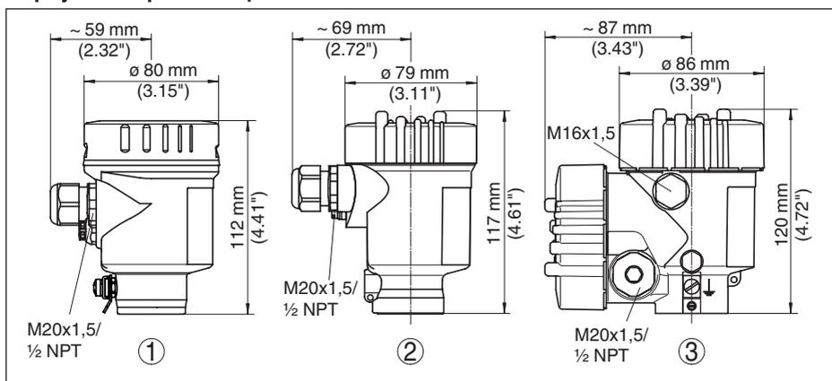
Рис. 61: Корпуса в исполнении IP 66/IP 68 (0,2 bar) - с установленным модулем индикации и настройки корпус выше на 9 мм/0.35 in
