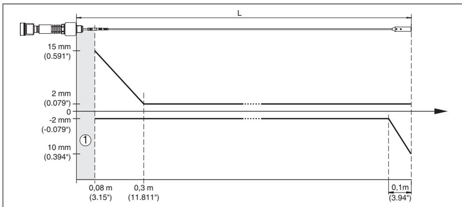
Рис. 52: Погрешность измерения VEGAFLEX 86 в тросовом исполнении (продукт - вода)
