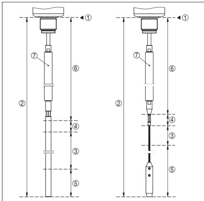
Рис. 15: Диапазоны измерения VEGAFLEX 86 с компенсацией пара
