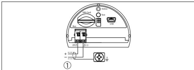
Рис. 28: Отсек подключения встроенного модуля мобильной связи PLICSMOBILE
