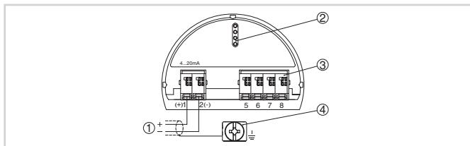
Отсек электроники и подключения (однокамерный корпус)
