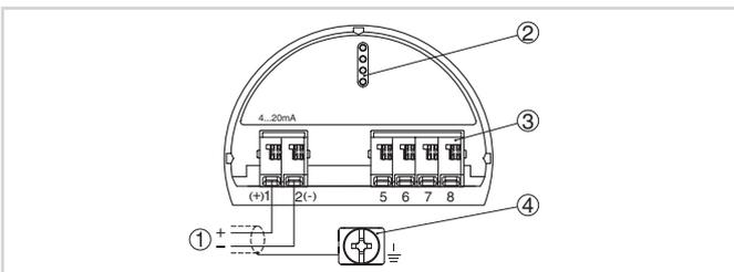
Отсек электроники и подключения (однокамерный корпус)
