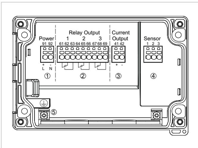
Схема подключения VEGAMET 841
