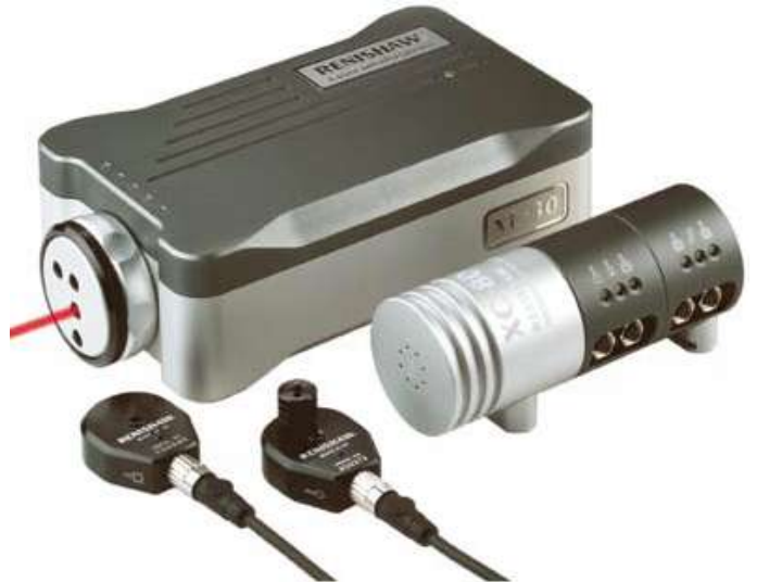
Юстирування та калібрування приладу по вісях за допомогою лазерного інтерферометра Renishaw XL-80. Створення файлу корекції
