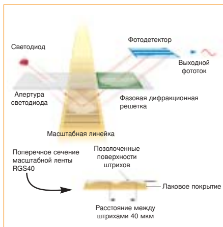
Оптическая схема энкодера RG4
