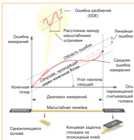
Метрологические характеристики линейки RGS20
