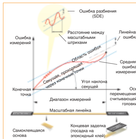
Метрологические характеристики линейки RGS40-S
