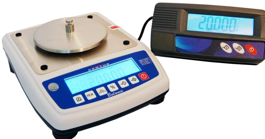
**ФУНКЦИИ:** выборка массы тары Max - 1e, масса брутто/нетто; 14 единиц измерения массы; взвешивание в процентах (%); счетный режим; функции суммирования и слежение нуля; сигнализация о перегрузке весов; сигнализация стабильности показаний весов; вывод на печать «дата, время, масса».
