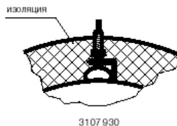
Крепление при помощи металлического уголка
