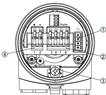
Отсек электроники и подключения - однокамерный корпус
