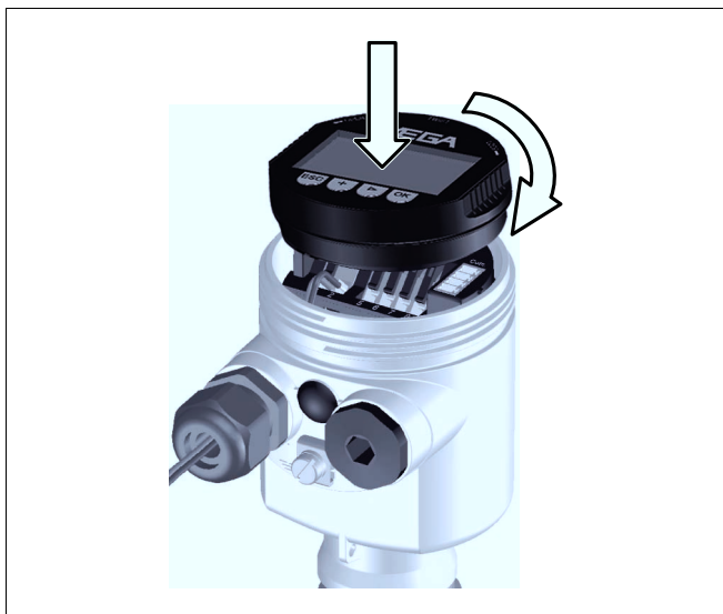
Рис. 16: Установка модуля индикации и настройки
